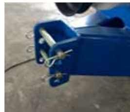
Ojo del timon desmontable y ajustable Verstellbarer und Abnehmbarer Zugöse Съемный и регулируемый механизм буксировки
