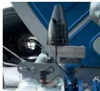
Electroválvula para cierre lento Elektroventil für langsames Schliessen Медленно закрывающийся электрический клапан
