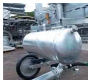
Tanque de agua usado como lastre Wasser-Ballast-Tank für Stativ Балластный бак с водой
