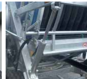
Levantamiento del carro con pistones hidráulicos Hydraulische Stativhebevorrichtung und Stützen hinten Гидравлический подъем спринклерной тележки
