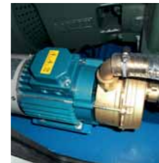
Electrobomba de cebado Vorrichtung für das Ansaugen in Unterdruck mit Elektropumpe Электрический самовсасывающий вакуумный насос
