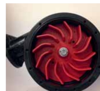
Turbina pintada en PLASCOAT Lackierung der Turbine mit PLASCOAT Окрашивание турбины PLASCOAT
